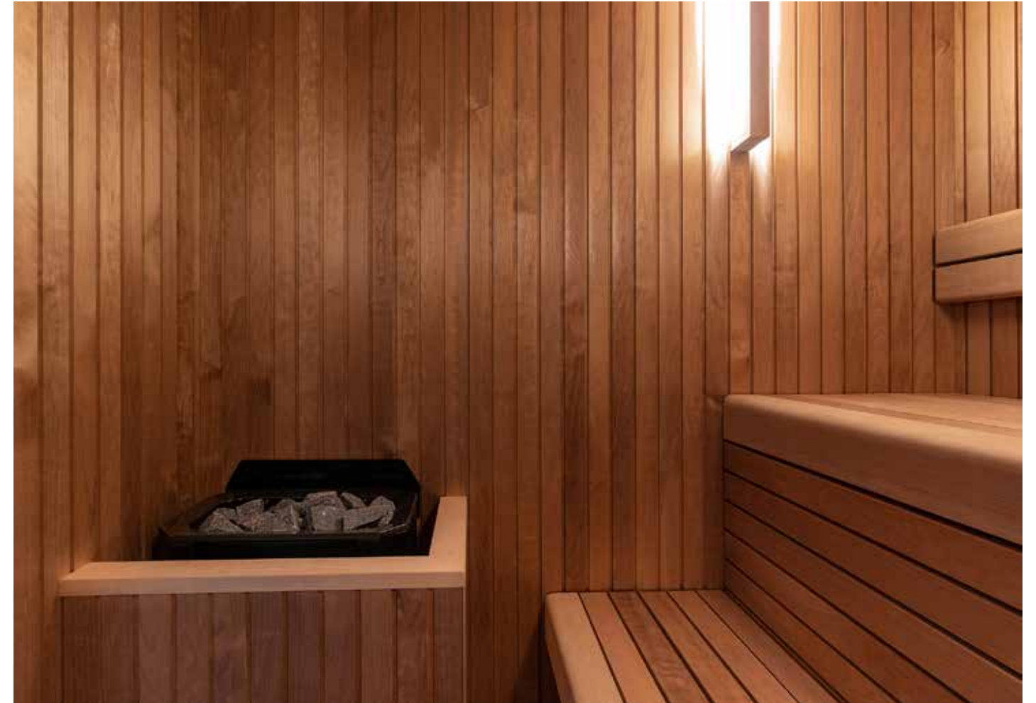
Perinteinen sauna, johon lämpökäsitelty haapa tuo ripauksen modernia särmää: seinät STS10 15 x 68 mm ja lauteet 28 x 65 mm. AUROOM DESIGN-SARJAN FAMILIA-SAUNA, SVEITSI
