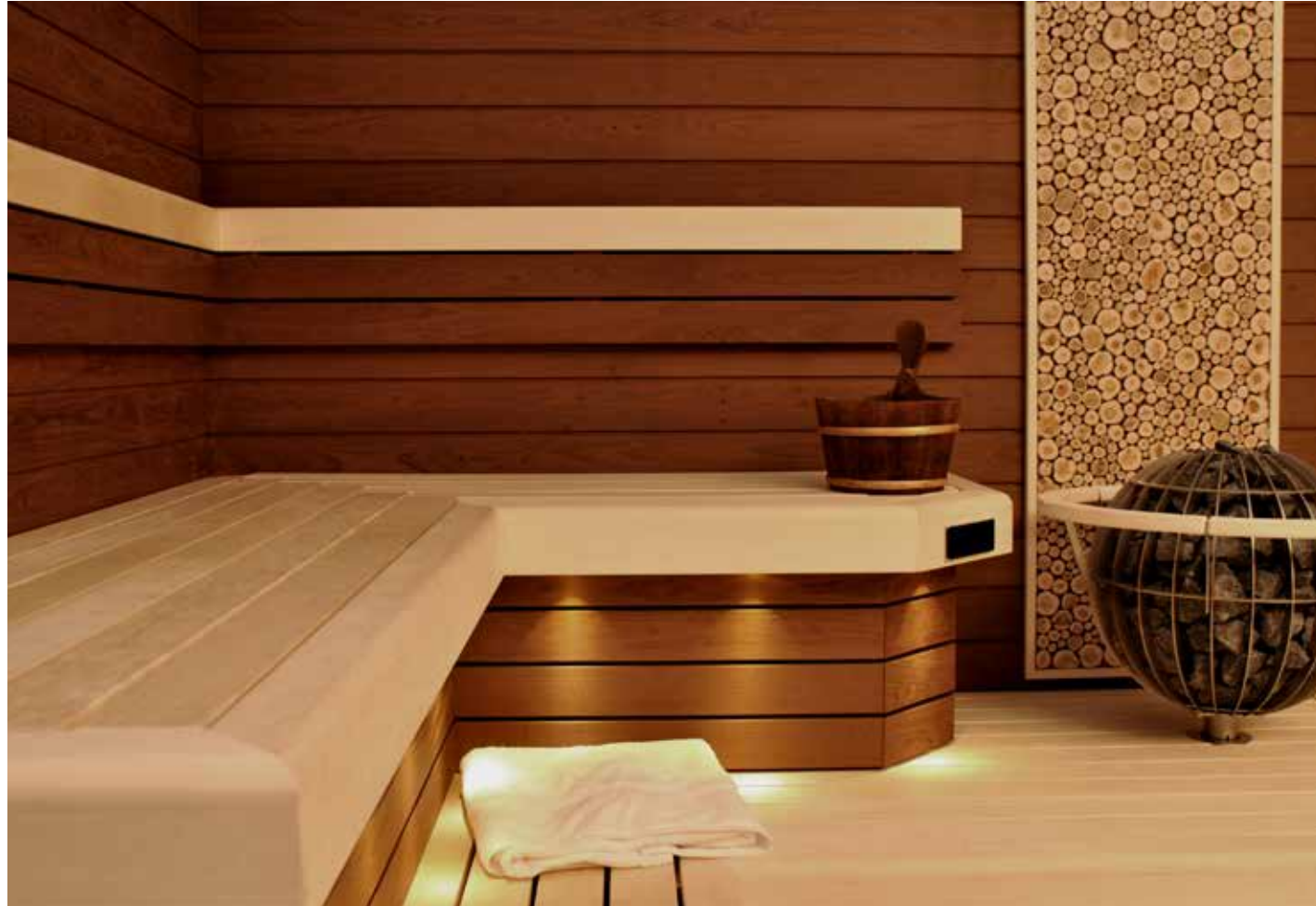
Tämä sauna on tyylikäs yhdistelmä tummaa harjattua lämpöleppää ja vaaleaa luonnollista haapaa: seinät STS10 15 x 120 mm, väliritilä ja selkänoja SHP 28 x 85 mm ja lauteet SHP 28 x 90 mm. YKSITYISSAUNA, VIRO
